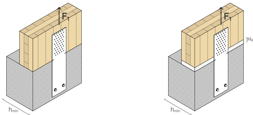
ESPESOR MÍNIMO DE HORMIGÓN  $h_{min} \geq 200$  mm
