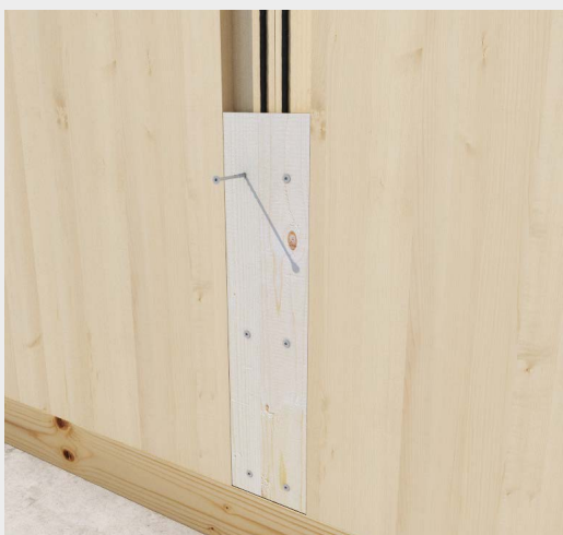
使用直径6 mm的HBS螺钉 紧固CLT墙体。
