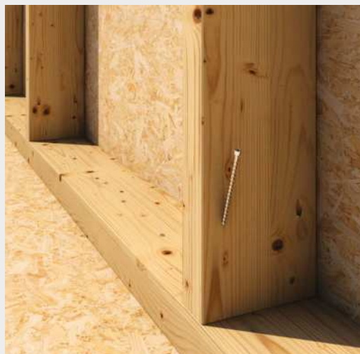
Upevnění sloupků lehkých rámových konstrukcí pomocí VGZ EVO Ø5 mm.
