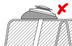
Εσφαλμένο βίδωμα εκτός άξονα
